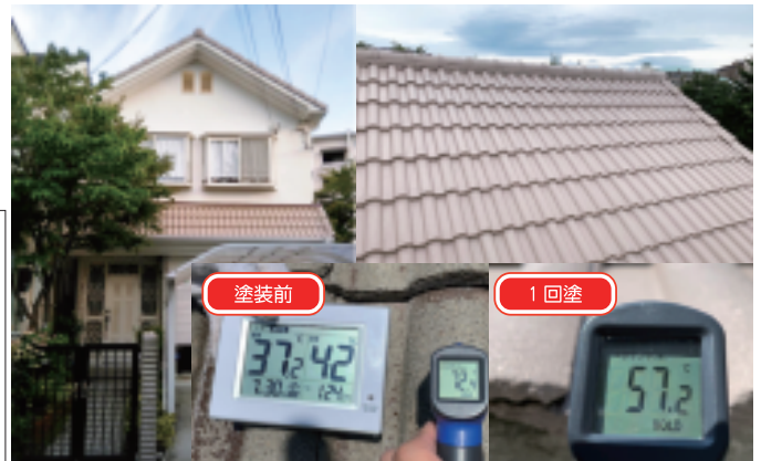
▲ 塗装前では外気が 37℃の際に屋根表面は 72℃を超えている状態でした。アドクール Aqua を施工する事で、表面温度は 15℃以上も低下しております。(なお、アドクール Aqua の仕様は 2 回塗の為、更なる効果が期待できます。)
